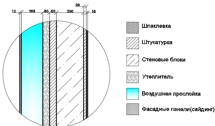
Рисунок 11 – Структура пирога наружных стен
